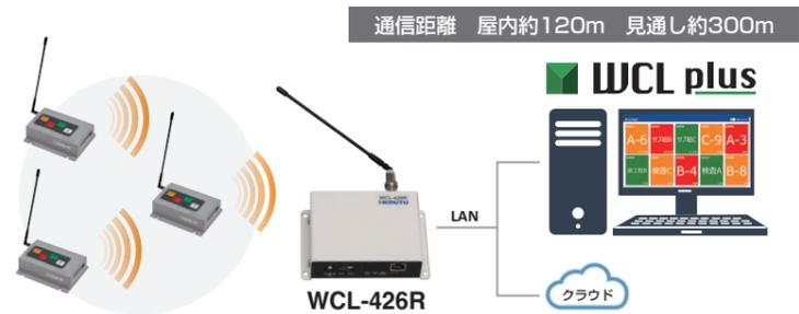
・WCL-426R 1台につき、最大800台のAN426TIIとワイヤレス通信可能であり、1工場内で最大10台のWCL-426Rを共存可能です。つまり、1工場内で最大8,000か所から呼び出しを受信することができます。
